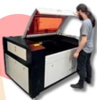
Pour tous nos élèves passionnés par la menuiserie : Un **découpeur graveur laser** ! L'objectif : Permettre aux élèves une **maquette en 3D de leur projet pour mise à l'échelle avant réalisation**.
